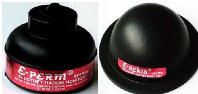
شکل ۱-۵. آشکارساز Electret Ion Chamber یا E-PERM
